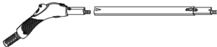
трубки в паровой пистолет до тех пор, пока спусковая кнопка парового пистолета не встанет на место. Используйте одну или две удлинительных трубки. Нажмите соответствующую кнопку разблокировки и разъедините трубы с помощью механизма, чтобы снять удлинительную трубку с пистолета.
